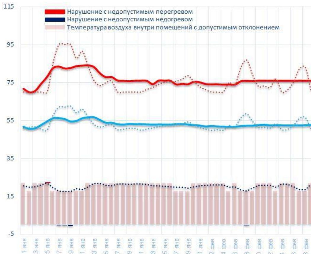
Рисунок 15 - Сопоставления значений фактических и расчетных температур теплоносителя в подающем и обратном трубопроводе Курской ТЭЦ СЗР (выше) и Курской ТЭЦ – 4 (ниже) в 2023 г., относительно параметров оптимального эксплуатационного графика.
